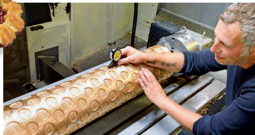
Qualitätsprüfung: Zerspanungsmechaniker Jürgen Johannes kontrolliert bei einer Gebäckformwalze aus Edelstahl die Tiefe der kurz zuvor gefrästen Muster.
